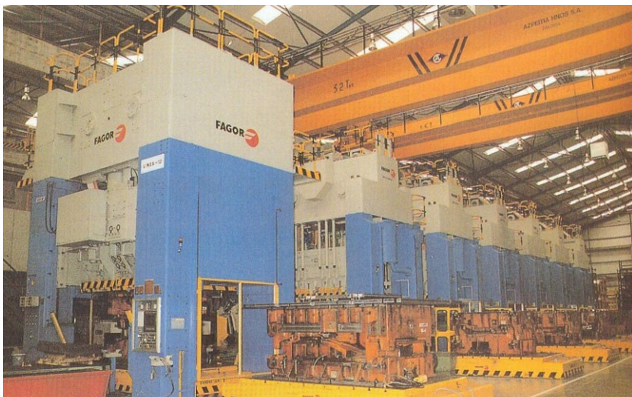
Fot. 3. Linia ciężkich pras do głębokiego tłoczenia elementów o dużych wymiarach
